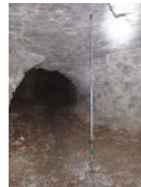
Canne de convergence visible dans la carrière « de Wett » sur la commune de Lille, faisant l'objet d'un suivi régulier depuis 20 ans © Service Commun des Carrières Souterraines Ville de Lille
