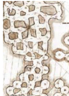
Plan d'une exploitation mixte : catiches en bas et piliers en haut © IFFSTAR
