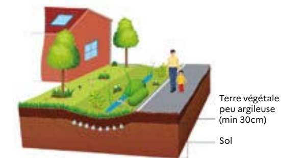
Noue d'infiltration simple © Adopta
